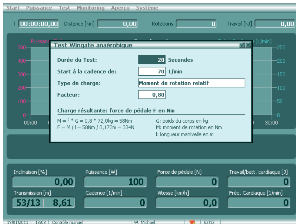
Dialogue par rapport à la configuration d'un test anaérobie de Wingate sur le cyclus2
