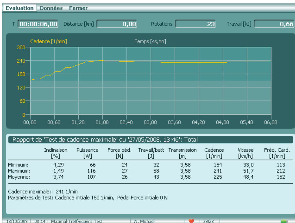
Visualisation de l'évaluation d'un test de fréquence de pédalage maximale
