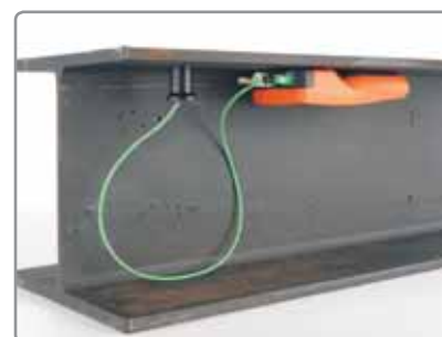
Surveillance à distance des paramètres climatiques
