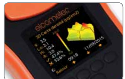
Profil de densité de sels en 3D avec Pics de concentration de sels
