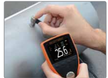
Idéal pour la mesure de tubes en acier avec une seule face accessible.
