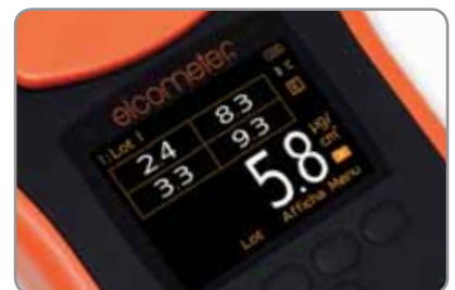
Mesures équivalentes à quatre patches de Bresle
