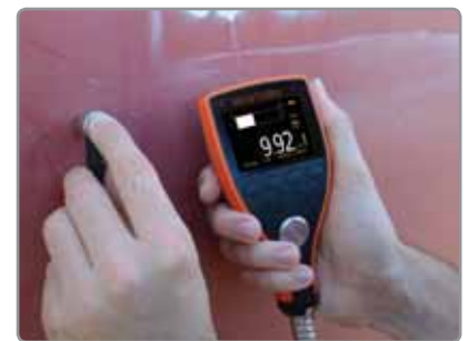
Idéal pour mesurer l'épaisseur de matériaux revêtus en faisant abstraction de l'épaisseur de revêtement (mode EE).
