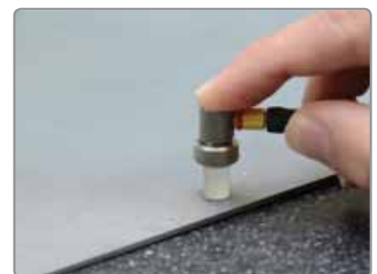
Idéal pour mesurer l'épaisseur de fines feuilles de métal non revêtues et autres substrats métalliques fins.
