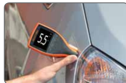
Ecran avec rotation automatique à 360° pour des mesures sous tous les angles
