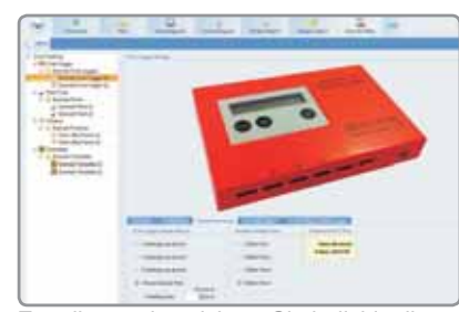
Erstellen und speichern Sie individuelle Ofenprofileinstellungen und übertragen Sie diese auf das Messgerät.
