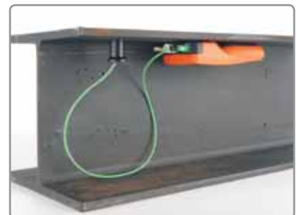
Fernüberwachung klimatischer Parameter
