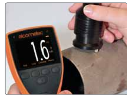
Integrierte oder separate Sonden zur Messung von Profilen von bis zu 500µm (20mils) auf flachen oder gekrümmten Flächen**
