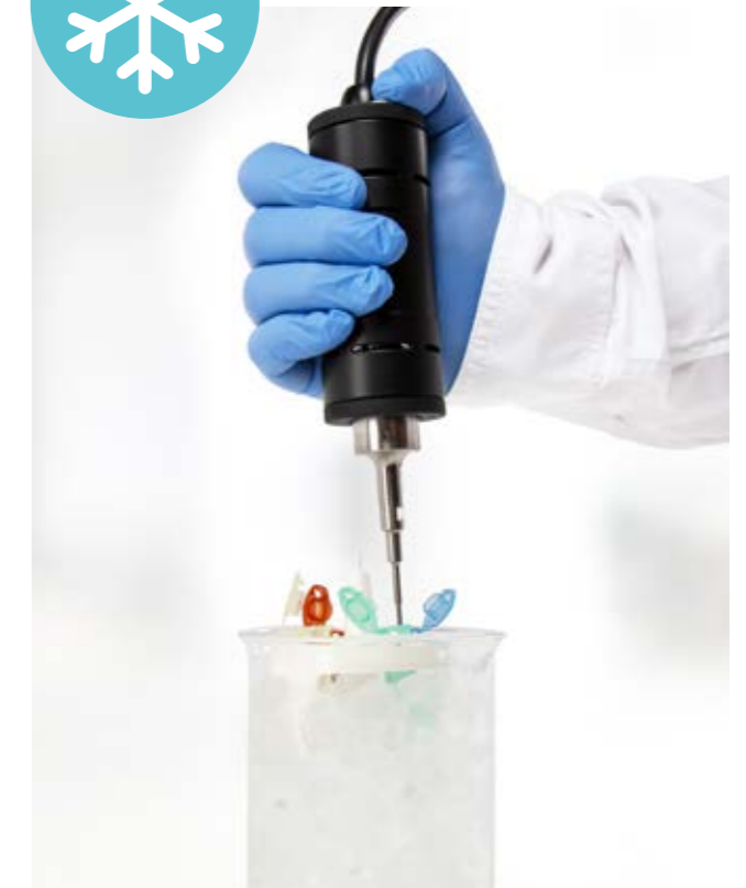
Kühlung mit Crushed Ice
