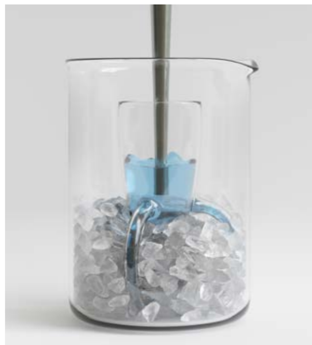
Kühlung der Probe in einer Rosettenzelle RZ mit Crushed Ice
