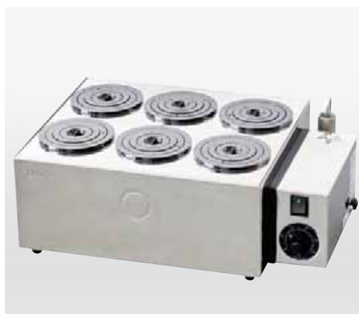
H 11 V mit Edelstahl-Außengehäuse, speziell für Arbeiten in Abzugsschränken
