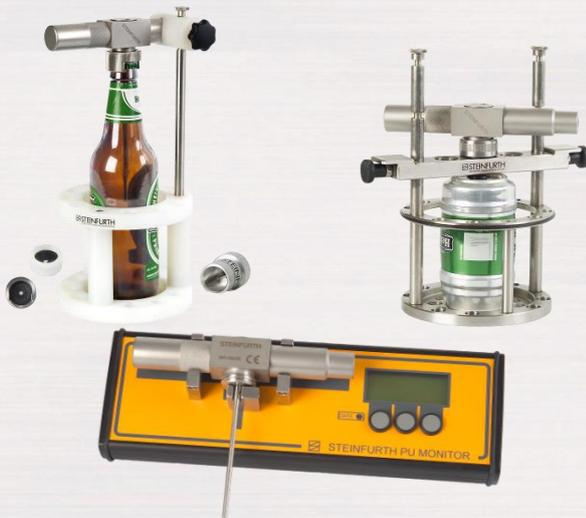
Das Steinfurth PastControl-System vereinfacht diese Kontrolle stark. Die sehr einfache Bedienung erfordert nur eine kurze Einweisung des Bedienpersonals. Dabei kann der PE-Wert bereits hier, an der Linie, ermittelt und ggfs. in die Produktion eingegriffen werden.
