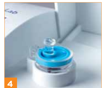
4 Abdeckung schließen. Ergebnis wird innerhalb von 4 Minuten angezeigt.
