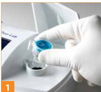
1 Barcode der LOT Kalibrierung scannen. Folie entfernen und in den Analyser einsetzen.
