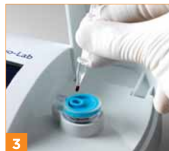
3 Probenstäbchen in die Kartusche einführen und Stiel abbrechen.
