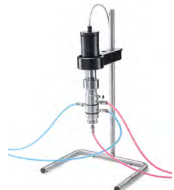
Beispielaufbau mit Durchflussgefäß DG 4 G
