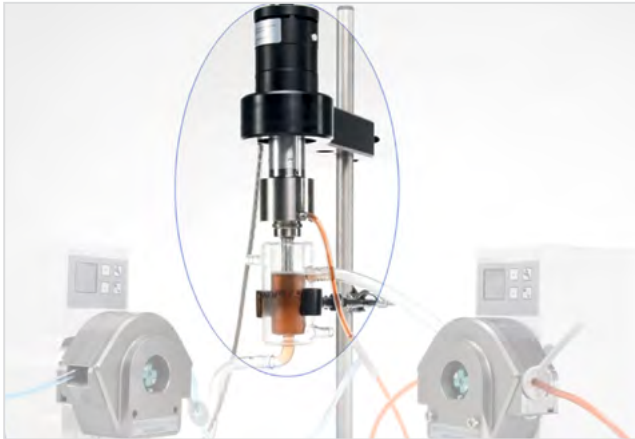
Beispielaufbau mit Durchflusshorn FZ 7 G und Durchflussgefäß DG 5
