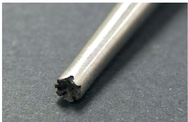
Beispiel einer Sonotrode mit Kavitationserosion
